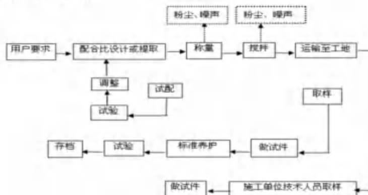
图 3 生产工艺流程图
