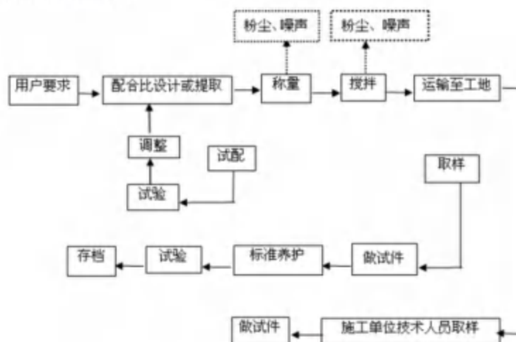
图3 生产工艺流程图
