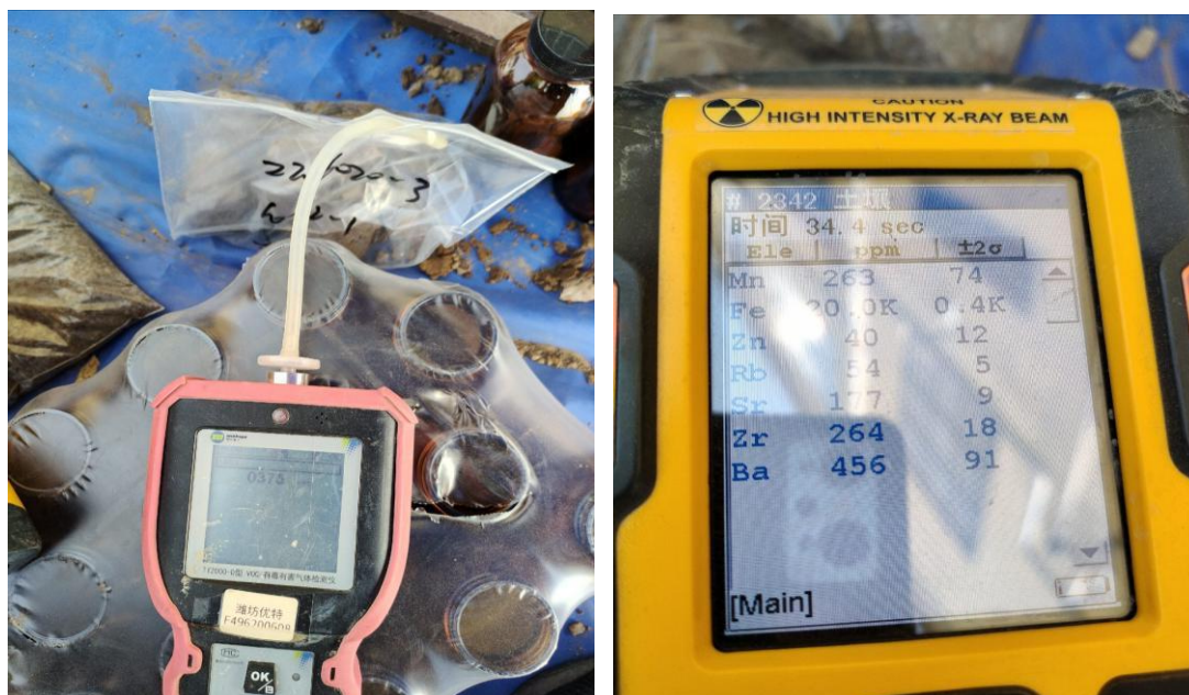
图 5.2.3 现场快速检测照片
