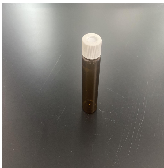
挥发性有机物采样瓶-地下水
