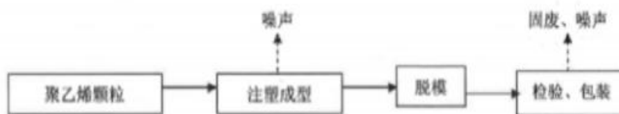
图 4.4-35 锚固件--塑料套筒工艺流程及产污环节图
