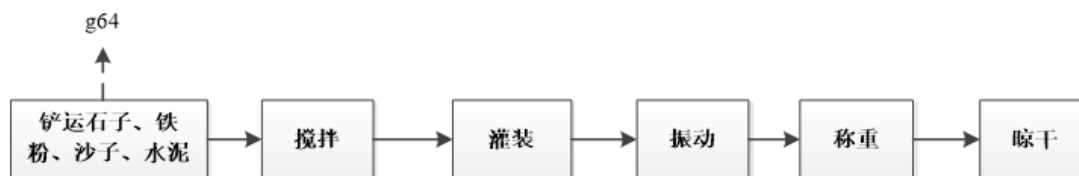
图 4.4-17 装载机配重灌浆工艺流程图
