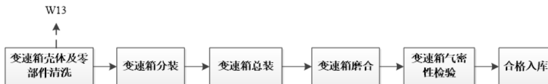
图 4.4-16 桥箱车间变速箱装配工艺流程图
