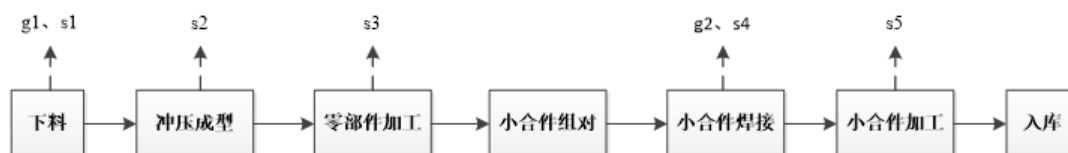
图 4.4-7 装载机厂房下料工序工艺流程图
